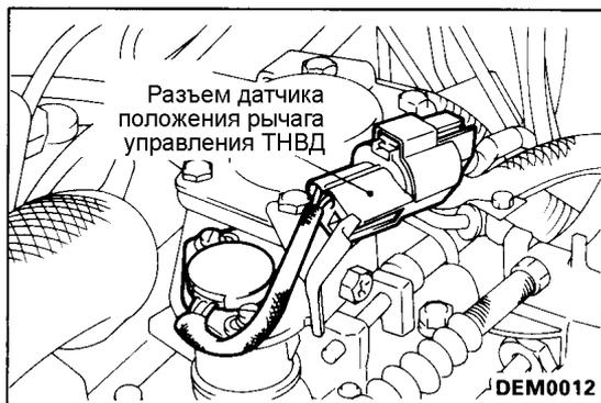
**РЕГУЛИРОВКА ДАТЧИКА ПОЛОЖЕНИЯ РЫЧАГА УПРАВЛЕНИЯ ТНВД (LPS)**
