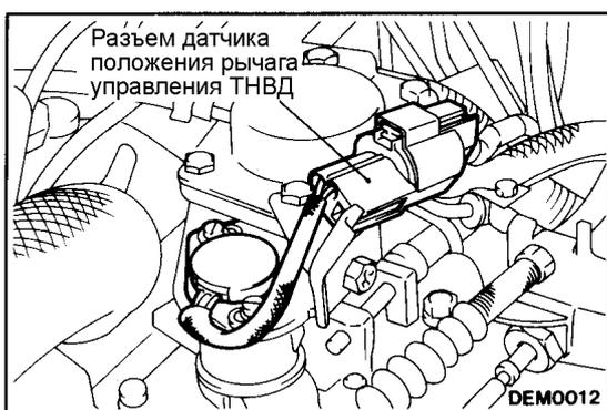
**РЕГУЛИРОВКА ДАТЧИКА ПОЛОЖЕНИЯ РЫЧАГА УПРАВЛЕНИЯ ТНВД (LPS)**
