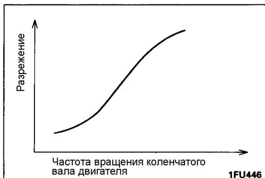
Запустите двигатель и проверьте, что увеличение разрежения происходит пропорционально увеличению частоты вращения коленчатого вала двигателя.
